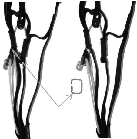
Abbildung 9 Apus RS Tragegurt mit und ohne Speedlimiter
