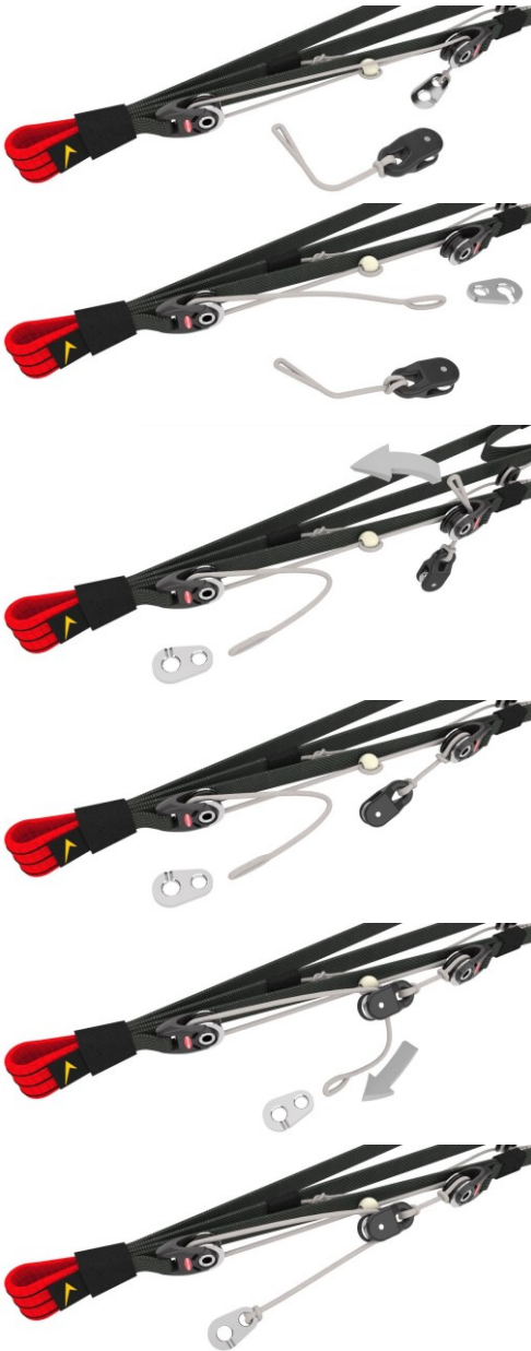
Abb. 10. Bildserie Speedlimiter Einbau
