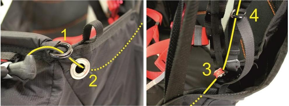
Abb. 21: Montage des Speedsystems
