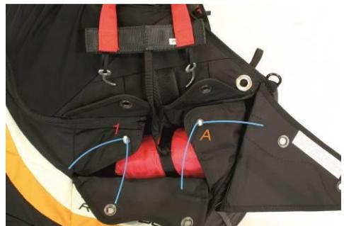
Abb. 8: Verschlussgummis mit Hilfsmittel
