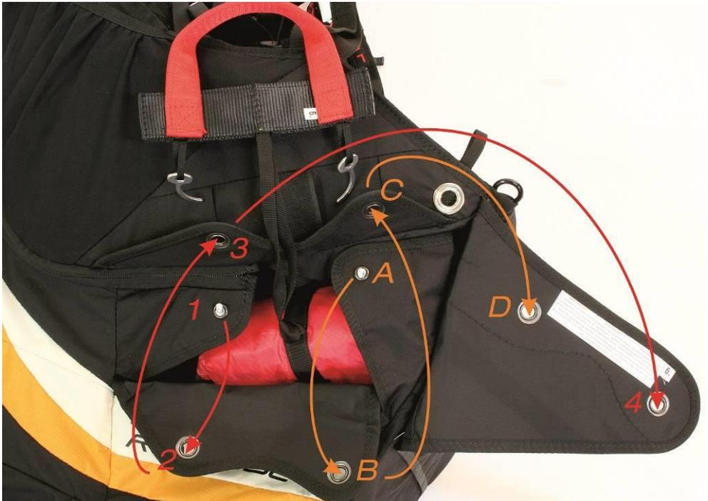
Abb. 7: Retter im Rettungsfach, Verschlussreihenfolge markiert
