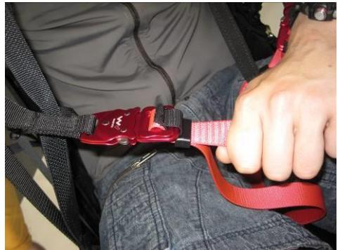
Abb. 20: Verkürzen einer Beinschlaufe
