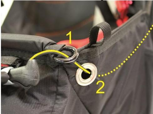
Abb. 21 am Gurtzeug angebracht. Zuerst wird sie durch den vorn unterm Sitzbrett angebrachten Ring (1) geführt, der mit einem Gummiband verbunden ist. Anschließend gelangt sie durch die Metallöse (2) in den Führungskanal. An dessen anderem Ende wird sie durch die Umlenkrolle (3) geführt. Nun muss sie nur noch durch den kleinen Ring (4) gefädelt und abschließend mit einem Brummelhaken verbunden werden.
