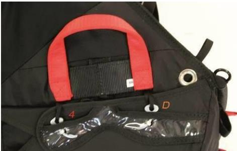
Abb. 11: Vordere Verschlusslasche mit Splinten gesichert, Auslösegriff verstaут
