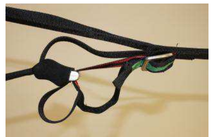
Bild 19: Trimmerband zu Kurz
