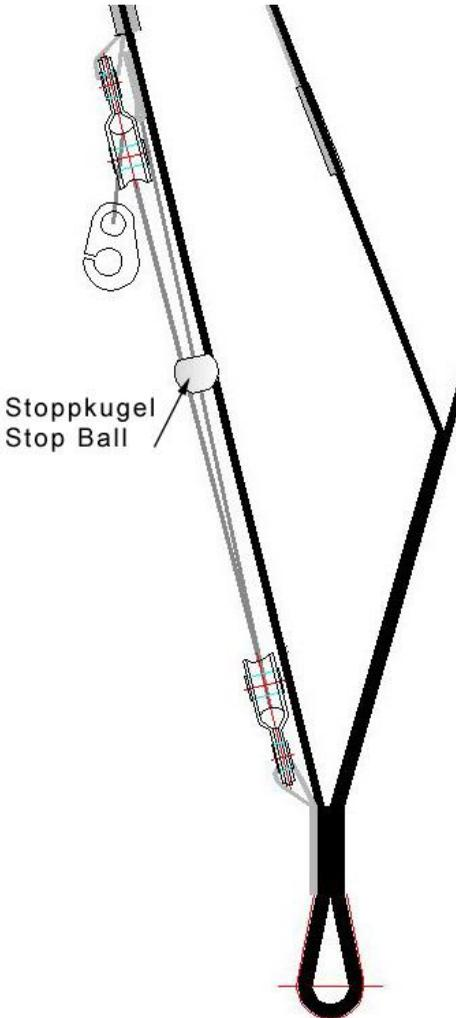
Beschleunigerdruck und ermöglicht so ein komfortables Beschleunigen auch mit angewinkelten Beinen. Im weiteren Verlauf blockiert eine Stoppkugel die untere Rolle, wodurch sich der Beschleunigerweg verringert und jeder Zentimeter effektiv in Geschwindigkeit umgesetzt wird.
