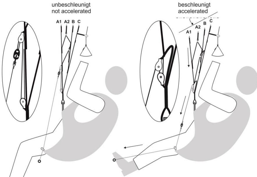
Abbildung 5: Funktionsweise Fußbeschleuniger Mistral 7
