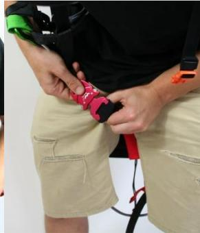
Abb. 31: Beingurt rechts schließen
