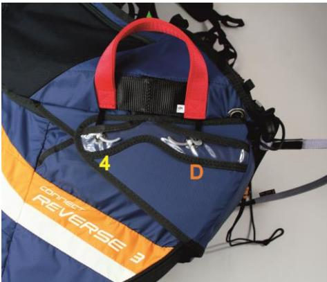
Abb. 10: Vordere Verschlusslasche mit Splinten gesichert, Auslösegriff verstaut
