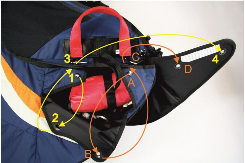
Abb. 6: Retter im Rettungsfach, Verschlussreihenfolge markiert
