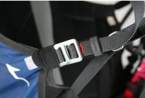
Abb. 13: Gesperrte Schnalle mit Markierung der Standard-Position
