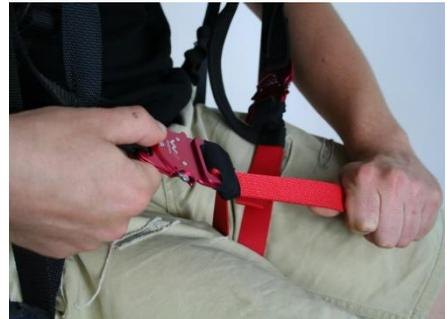
Abb. 19: Verkürzen einer Beinschlaufe
