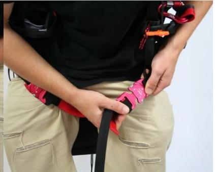
Abb. 32: Beingurt links schließen
