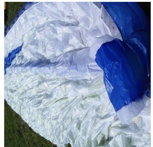
Die „Wand“ einer Zelle einmal nach außen gekehrt. Die blau schimmernde Linie im Schirm zeigt die Lage der eingenähten RAST-Ventile.. // Foto: Lu-Glidz
