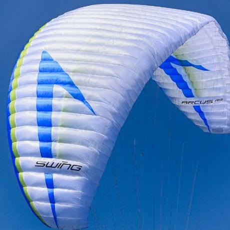
Mit einem ausgeklügelten Materialmix aus 32g und 27g Tüchern und einer materialsparenden Konstruktion des Innenlebens, ist der ARCUS RS LITE bis zu 1,1 kg leichter. Ideal für Biwakflieger, sicherheitsbewusste Hike&Fly-Piloten und Globetrotter, die gerne mal einen leichten und kleinen Schirm im Gepäck haben.
