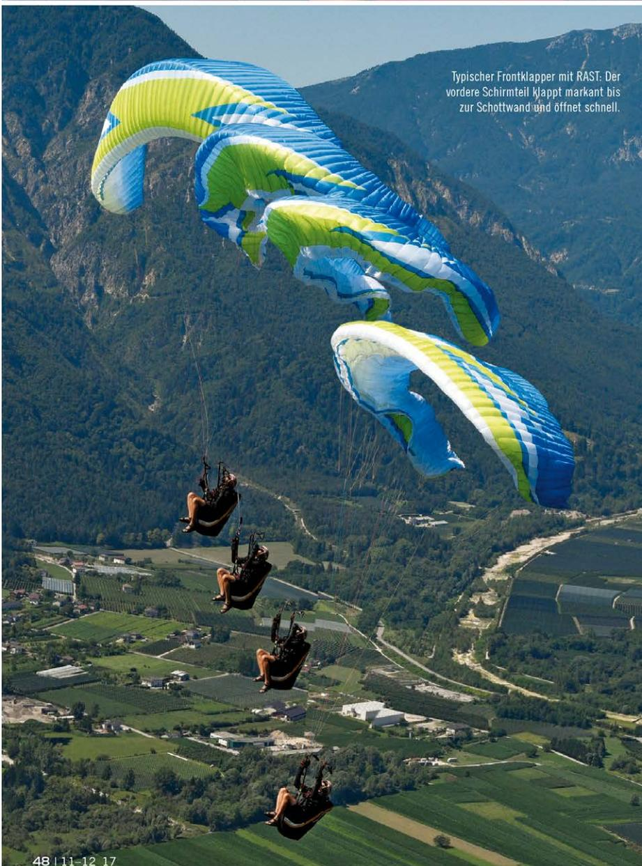
Typischer Frontklapper mit RAST. Der vordere Schirmteil klappt markant bis zur Schottwand und öffnet schnell.
