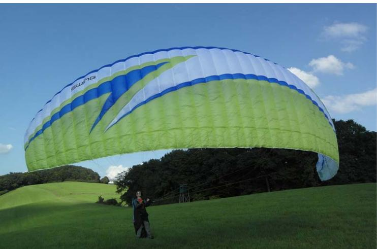
Beim Start füllt die Kappe im vorderen Drittel (vor der Wand) sogleich, der Hinterflügel etwas verzögert. Der Schirm steigt sehr konstant. Vor der der Hinterkante ist die zusätzliche Naht eines 3D-Shapings zu sehen. // Foto: H. Schlegel
