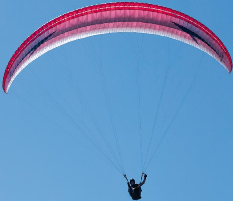
Fast 90 % der Last hängt auf der A- und B-Ebene, die C-Ebene hat lediglich eine Stützfunktion ...
