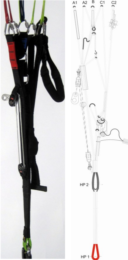
Abb. 14. Tragegurt mit zwei Aufhängepunkten
