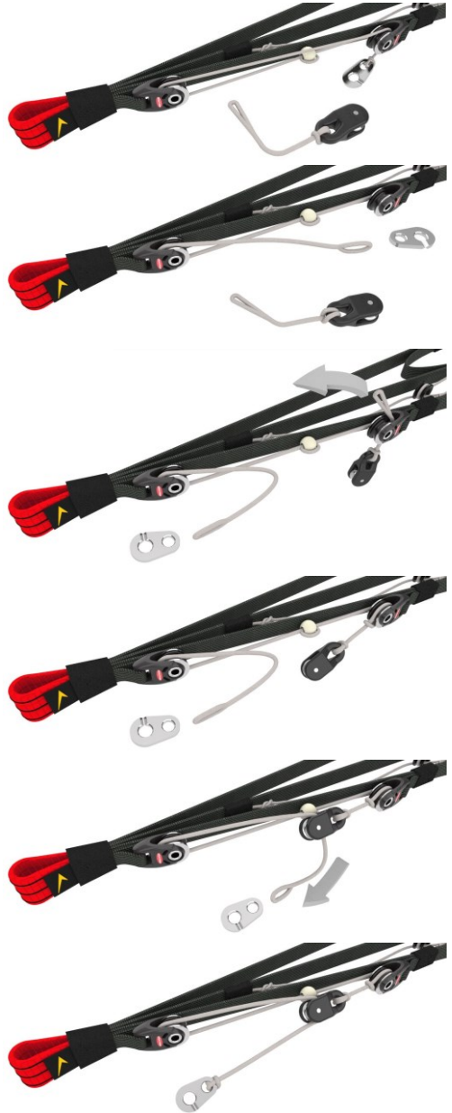
Fig. 10. Installation du Speedlimiter
