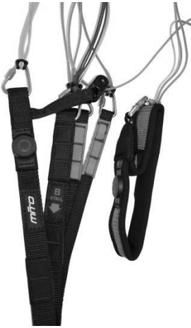
Fig. 7 Tragegurt mit Bremsgriff
