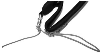
Fig. 11 Herausziehen der Leine aus der Schlaufe
