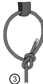
Fig. 4. **Palstek-knot**
